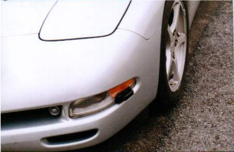
Capteur infrarouge numérique du SADL en situation sur un véhicule de la gamme sport.
